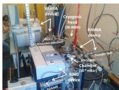
Figure 7 : Dispositif utilisé pour les expériences VAHIIA et RAHIIA
